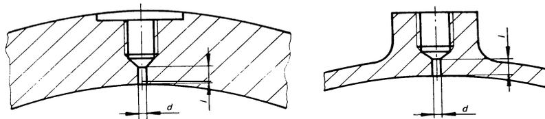
$$l = 2,5 d, \text{ donde } d = 3,18 \text{ a } 6,35 \text{ mm}$$
