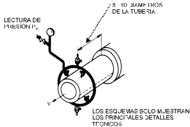
**FIGURA 2A Instalación de las tomas de presión**
